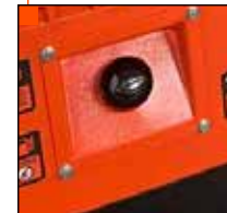
Tanque de Combustible con capacidad de 90L
