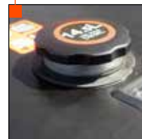
Tanque de Combustible con capacidad de 14,5L
