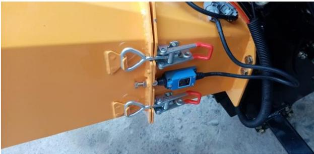
**Apertura de Tolva.** Fácil sistema de apertura que permite acceder a los cuchillos de la chipeadora, con solo soltar 2 abrazaderas en forma manual.
