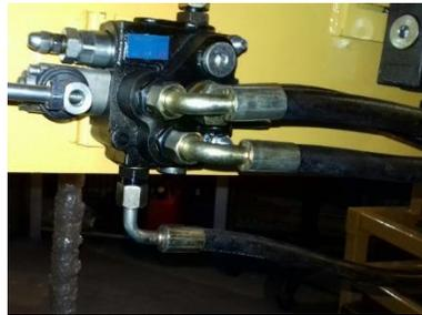
Permite establecer si el rodillo impulsa hacia los cuchillos la madera o la impulsa en reversa, hacia afuera.
