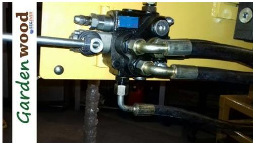
Permite establecer si el rodillo impulsa hacia los cuchillos la madera o la impulsa en reversa, hacia afuera.
