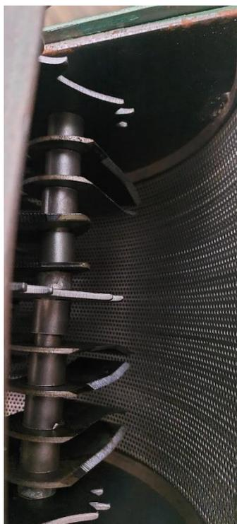
En primer lugar, los materiales se introducen en la cámara del molino típicamente por gravedad.
